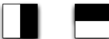
Figura 3.6: Haar-wavelet utilizzate per i SURF.
