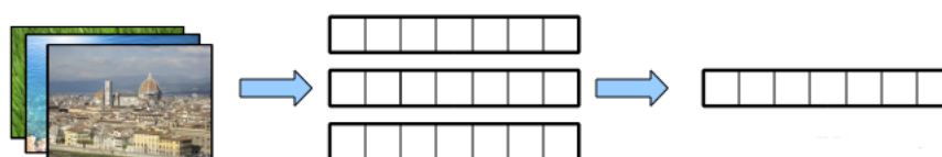
Figura 4.7: Ogni array rappresenta le k immagini simili per uno dei 3 frame. Da questi tre ne otteniamo uno che contiene i massimi dei 3 e rappresenta le prime k immagini simili per lo shot. Siamo passati da una similarità per frame a una per shot.
