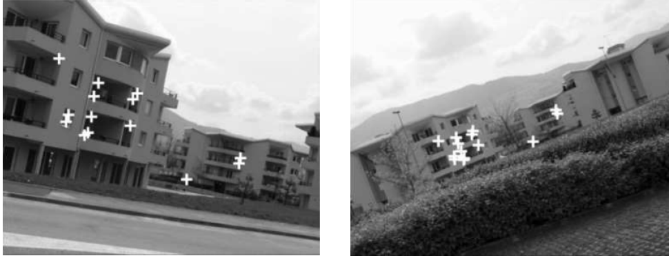
Figura 2.3. Punti rilevati dall'operatore di Harris esteso con funzionalità di selezione automatica della scala; i punti sono usati per una stima robusta dell'omografia tra le due immagini.
